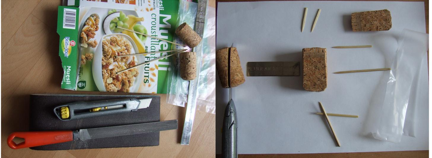
Le premier bouchon est coupé dans la longueur en biais, 1/3 – 2/3, le 2/3 devient la coque, sur le côté rond, au cutter, une fente perpendiculaire est pratiquée, c'est le puits de quille.
