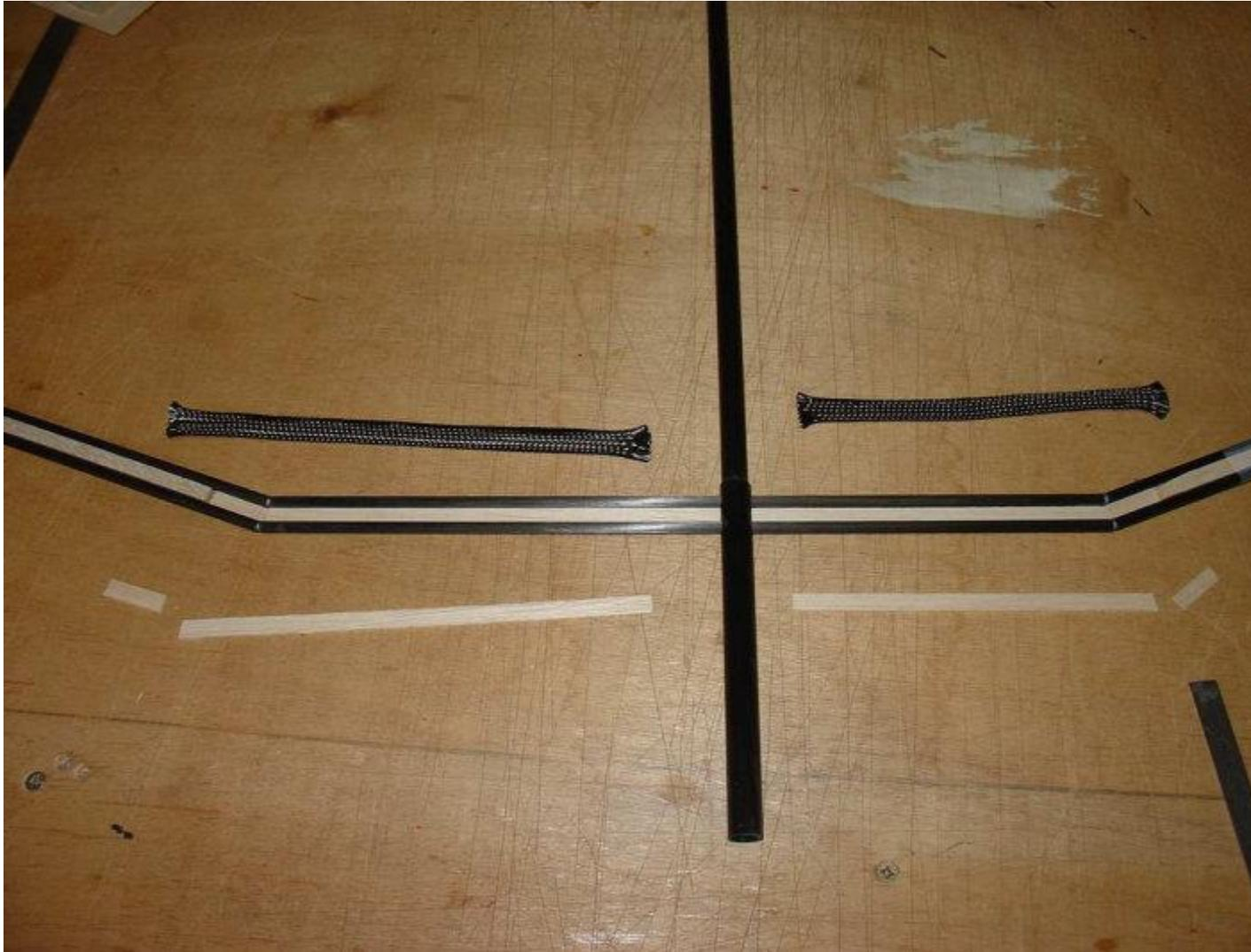
10) l'ensemble est ensuite mis sous presse avec de la résine, entre deux plaques de polystyrène extrudé (styrodur par exemple) protégées par du polyane ou du polyéthylène j'utilise depuis longtemps du sac poubelle noir, qui en fait est gris à l'extérieur. attention de ne pas laisser en apparent le côté avec les impressions du sac poubelle, elles se transfèrent sur le moulage !!!!!!!!!!!!!!! pour info, les sacs que j'utilise
