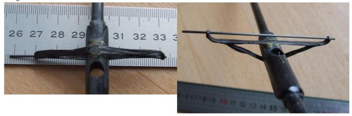
Pour tenir le point d'amure de la GV, le ponté en fil d'inox de 0,3 mm passe dans une petite encoche façonnée dans le trou du mât et un petit trou sur le dessus de la bôme Images Pocket-balest-bôme-5-6
