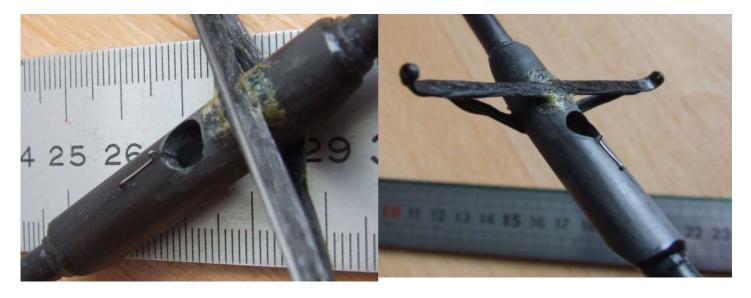
Le ressort du point d'écoute de la bôme est fait en fil d'inox de 0,5 mm sur un rond inférieur au tube de la bôme pour ensuite serrer à l'assemblage, cet élément doit être absolument assemblé avant le ressort du point d'écoute de la GV, la tige d'accrochage du bout d'écoute est en fil d'inox de 0,3 mm, le premier anneau laisse passer la tige en entier, dans le deuxième anneau ne passe que l'extrémité de la tige, le retrait ou la mise en place se font suivant les images
