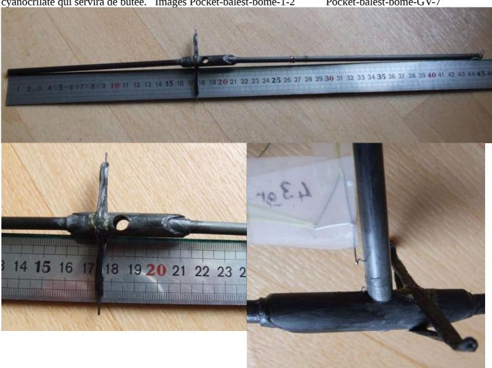
Le petit cintre retourné est fabriqué en mèche de carbone, résiné à la cyanocrilate sur un moule puis collé à la colle contact pour permettre son réglage, la tige est un jonc de carbone de 1mm Images Pocket-balest-bôme-3-4
