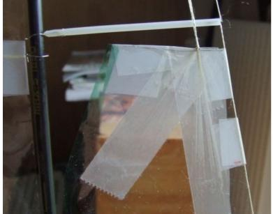
La GV a une têtière constituée d'un morceau de tube carbone, vu la taille de la tête, le scotch suffit largement sans renfort, le petit bout qui part de l'arrière jusqu'à l'accrochage de la voile empêche le crochet de glisser vers l'avant, l'axe de pivot de la GV est un morceau d'inox ou de titane de 2 mm courbé, le petit crochet est en 0,5 mm, en tête et bord de fuite est ajoutée une flamme qui permet de visualiser le bon écoulement d'air de la GV
