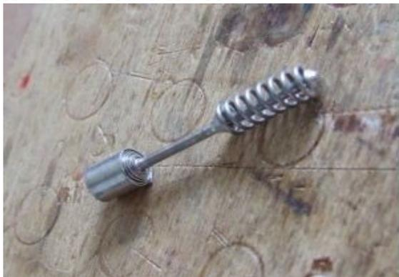
Assemblez dans le pignon de sortie, l'ensemble monté, la tige à ressort ne doit dépasser que de 16,0 mm. Votre axe de vis sans fin est prêt.
