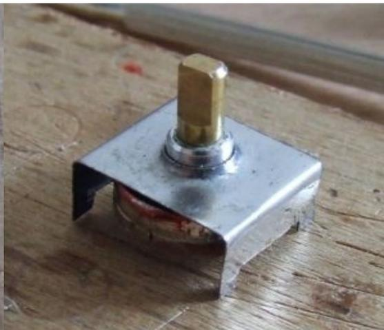
Repérez le sens de rotation du potentiomètre avec le pignon de sortie, sur un post-it, avec un petit dessin, déduisez le positionnement du potentiomètre dans le boîtier, la flèche représente le sens de déplacement de la partie visible du pignon, réfléchissez bien, même si vous vous trompez de sens, il suffira d'inverser l'alimentation du moteur après coup.
