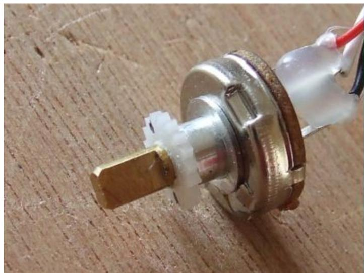
Prendre un bout de tôle, en fer et pas en aluminium comme j'ai tenté, couvercle de boîte de conserve, de bidon d'huile, de chicorée, de café, faites un trou de 3 mm, en utilisant la partie conique d'un mini tournevis puis son frère un peu plus grand, agrandissez le trou en le faisant tourner et osciller toujours du même côté, le but est d'agrandir le trou en lui faisant une portion cylindrique, ajustez serré, du côté arrondi, sur la partie grise en aluminium du potentiomètre.
