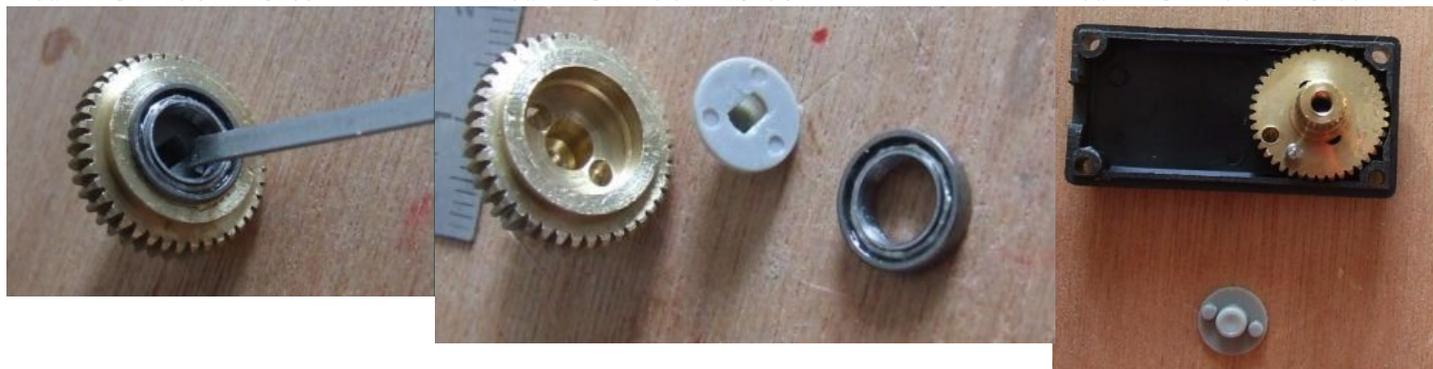
Arrondir le bord côté intérieur du trou de la vis de guignol.
