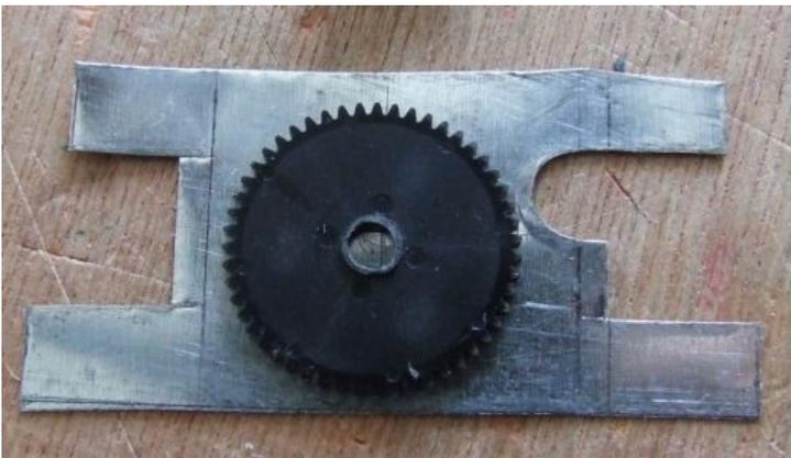
Percez avec un foret de 3, agrandissez en utilisant la partie conique d'un mini tournevis puis son frère un peu plus grand, agrandissez le trou en faisant tourner et osciller le tournevis toujours du même côté, le but est d'agrandir le trou en lui faisant une portion cylindrique, ajustez serré, du côté arrondi, sur la partie grise en aluminium du potentiomètre. Ces quatre images ne présente pas le support mais l'action pour obtenir ce trou épaulé.
