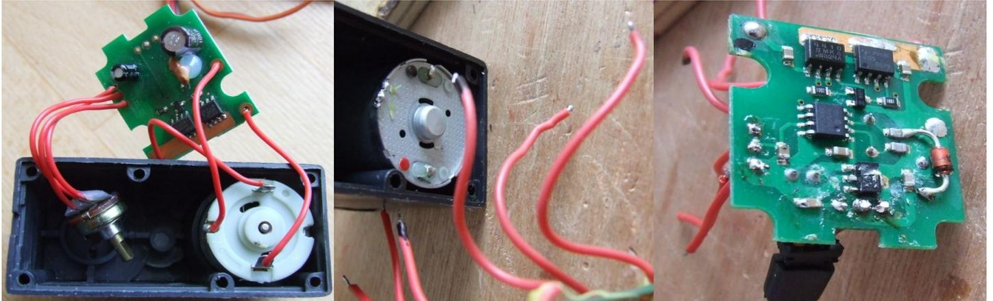
Dévissez la vis de maintien du potentiomètre et sortez le en poussant par le trou de liaison avec l'axe de sortie, rabattez le doigt anti rotation du potentiomètre qui refermera le trou carré d'où il vient.
