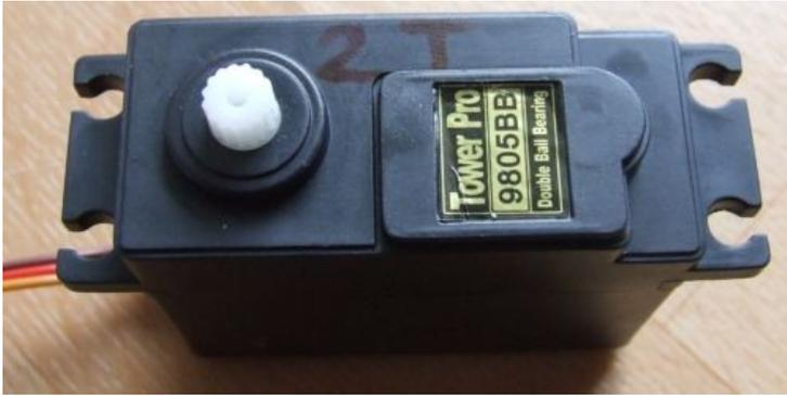
Évidemment, ce n'est pas un treuil, AA-Part italien ou MRG Australien, mais pour 12€ et votre main d'œuvre, quelle que soit la radio, 40, 72 Mhz ou 2,4Ghz, ça marche, reste à fabriquer le tambour au bon diamètre pour enrouler la longueur d'écoute voulue
