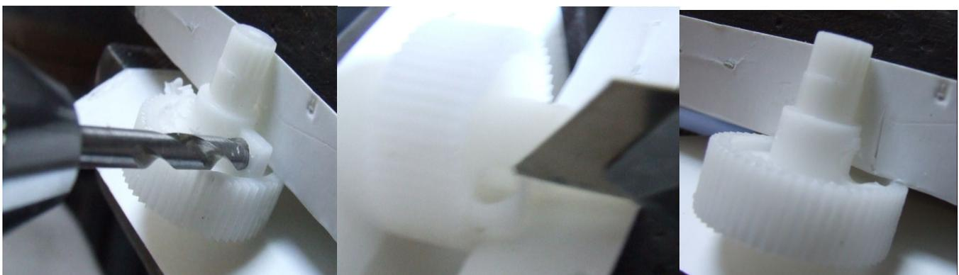
Le corps intérieur de pompe a un coté avec un diamètre plus petit, gardez le intact, ce coté recevra l'axe du pignon de 6 dents, jusque là, tout s'assemble serré, mais pas trop pour éviter de déformer les éléments, l'autre coté sera inséré dans la rondelle plastique de commande
