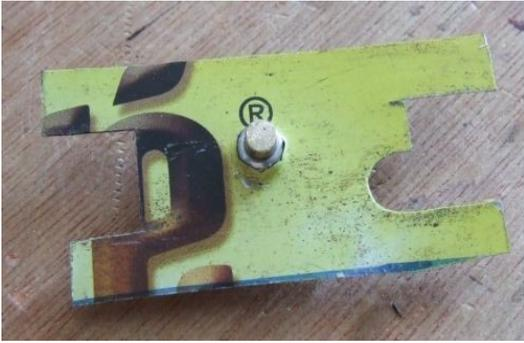
Pliez les pattes du support, dans le bon sens, assurez vous qu'il rentre dans le boitier avec un minimum de jeu, mais sans frotter, assemblez le potentiomètre, le pignon 48 dents, et ajustez.
