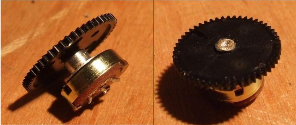
Le support du potentiomètre est fait avec un bout de tôle de 3 dixième d'épaisseur issue d'une boîte de conserve ou de chicorée, ou, mais doit être plane.
