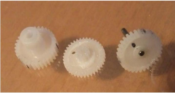
L'axe du potentiomètre est raccourci à 5 mm, le perçage du pignon, N°1, de sortie du mini-servo est agrandi au diamètre du potentiomètre, mais doit s'emboîter serré, et raccourci à 5 mm aussi.
