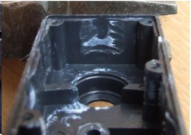
Sur un post-it, avec un petit dessin, déduisez le sens de rotation du potentiomètre dans le boitier, les flèches représentent les sens de rotations des pignons, dans le cas présent, vue qu'il y a deux engrènement, le sens de rotation du potentiomètre sera le même même, donc les fils seront soudés aux mêmes endroits, si vous vous trompez de sens, il suffira d'inverser l'alimentation du moteur après coup.
