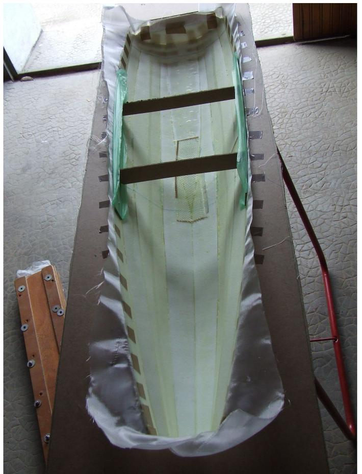
Posé sur deux tréteaux, drapé intérieur au 50gr, résiné à l'époxy, maintien de la forme avec deux entretoises, parce qu'il restait un peu de résine, pose des renforts de cadènes et de puits de quille.
