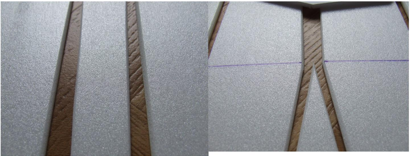
Chanfreinage des champs des bordés suivant l'angle avec le précédent et le suivant.
