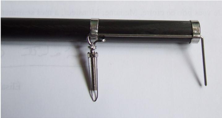
Quand l'ajustage est fini, démontez les pièces, poncez superficiellement l'intérieur des cerclages-paliers et la zone du tube en contact, assemblez le tendeur sur l'axe et positionnez les paliers avec l'axe au mieux et les coller à la cyanocrilate sans toucher l'axe du vit-de-mulet, et réservez.
