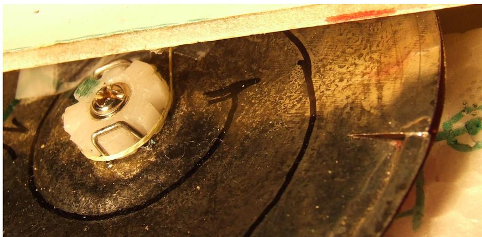
A droite sur la photo, fente du disque sur 1 cm pour faire passer la gorge du dessus au dessous, à gauche, fixation du tambour sur la tête du servo.
